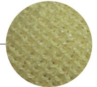
Support en aramide pour une résistance au contact de la chaleur jusqu'à 250 degrés pendant 15 secs.
